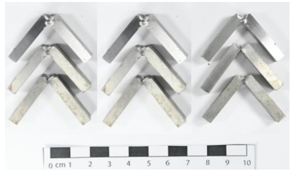
รูปที่ 23 ลักษณะชิ้นงานตัวอย่างภายหลังการทดสอบแรงกระแทก
