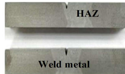
รูปที่ 10 การเตรียมชิ้นงานเชื่อมสำหรับการทดสอบการกระแทก
